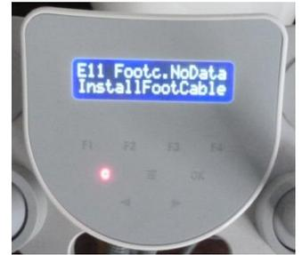
La ligne du bas vous donne des pistes sur ce que vous pouvez faire pour résoudre le problème. Si dans cet exemple vous utilisez une pédale de commande sans fil, essayez de brancher un câble de commande sur celle-ci. La raison expliquant ce code d'erreur peut être une batterie faible ou un brouillage du signal sans fil.
