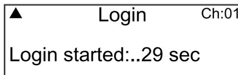
Pendant le décompte de 30 secondes, une combinaison de touches doit être exécutée sur la pédale de radiocommande dans l'ordre exact.
